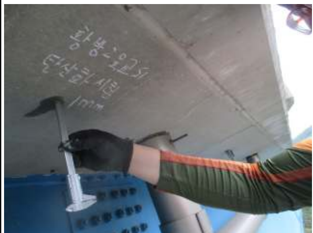
콘크리트 탄산화시험(탄산화 깊이측정)
